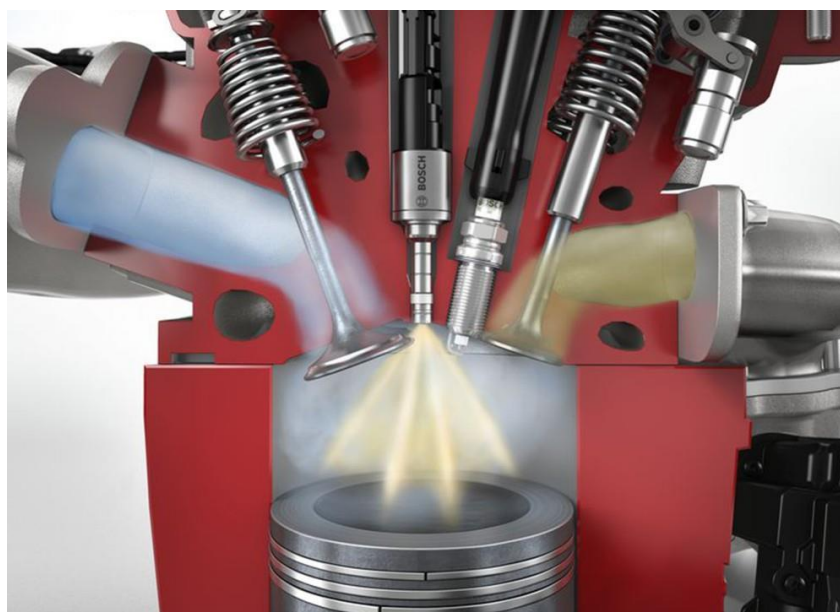
Kuva 2. Suorasuihkutuksen periaate (Bosch 2018).
