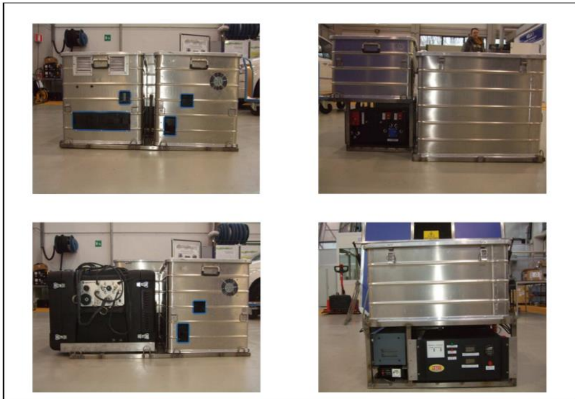
Kuva 17. Suojakoteloon asennettu PEMS mittalaitteisto (Bonnell ym. 2013: 18).
