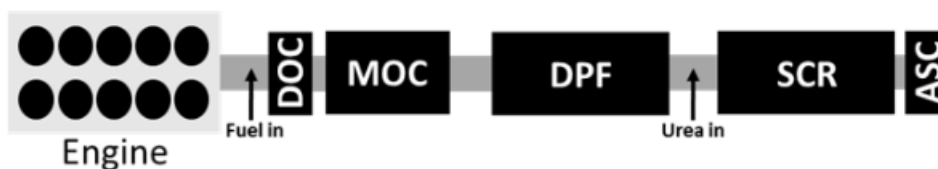
Kuva 13. Metaanihapetuskatalysaattorilla varustetun kaksoispolttoainemoottorin pakokaasujen jälkikäsittelylaitteisto (HDGAS 2018).
