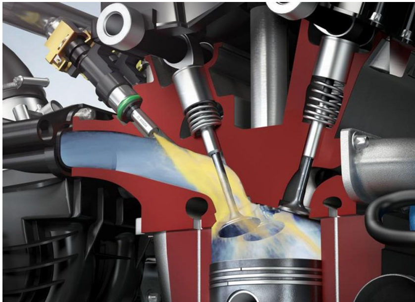
Kuva 1. Imukanavasuihkutuksen periaate (Bosch 2018).
